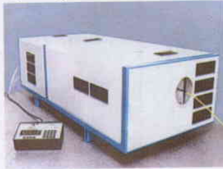
الشكل 8- صورة فوتوغرافية لوحدة ياغ أنجزتها شركة طومسون CSF ليزر. (خرج الاستطاعة الليزرية بليف ضوئي).
