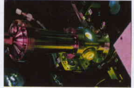
الشكل 10- انضخّات الصباغة: على اليسار مخطط لمبدأ التضخيم وعلى اليمين صورة فوتوغرافية لمضخّم طورته مفوضية الطاقة الذرية.
