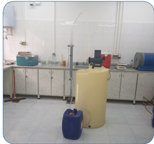
الشكل 2. العمود الذي تم تصنيعه لإجراء تجارب إزالة المواد العضوية من حمض الفسفور الغذائي.
